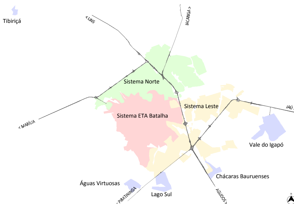
Figura 8.1 – Subsistemas de abastecimento de água tratada
