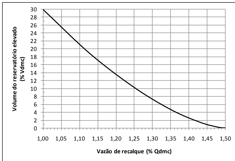
Figura 8.3 - Relação entre a capacidade do reservatório elevado e a vazão de recalque entre os reservatórios semi-enterrado (ou apoiado) e o elevado para um volume de armazenamento total de 30 % do Vdmc
