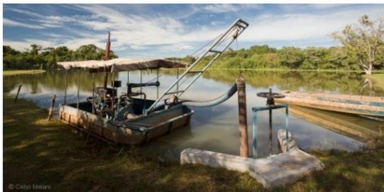
Figura 5.10 – Draga para limpeza do lago (arquivo da Hidrosan, 2013)
