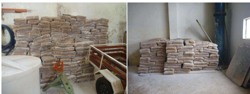
Figura 5.88 – Armazenamento de sacos extras de cal hidratada
