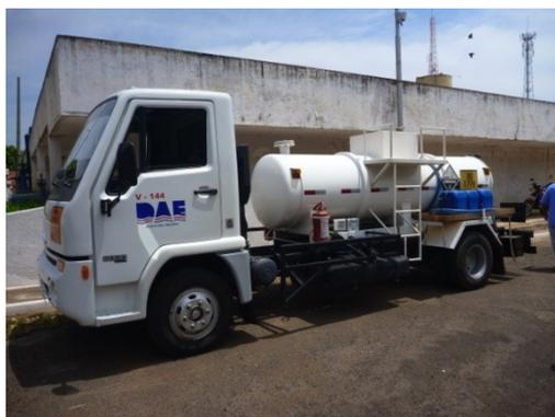
Figura 5.94 – Caminhão-tanque para transporte de ácido fluossilícico para os sistemas de fluoração das águas produzidas nos poços
