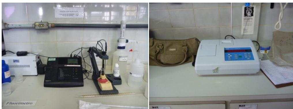
Figura 5.71 – Equipamentos do laboratório completo da ETA (potenciômetro/íon seletivo e turbidímetro)
