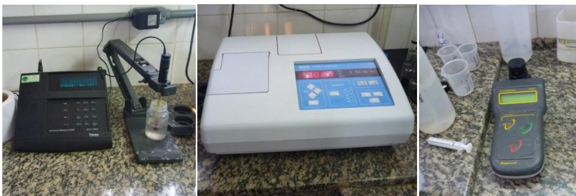
Figura 5.68 – Equipamentos de análise do laboratório de medidas rápidas (turbidímetro, potenciômetro e colorímetro)
