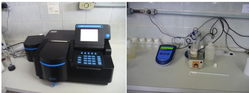
Figura 5.70 – Equipamentos do laboratório completo da ETA (espectrofotômetro e potenciômetro)
